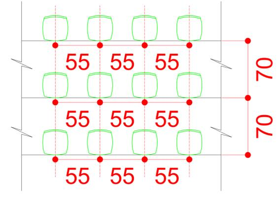
DETALHE 1 INSTALAÇÃO DOS ASSENTOS
