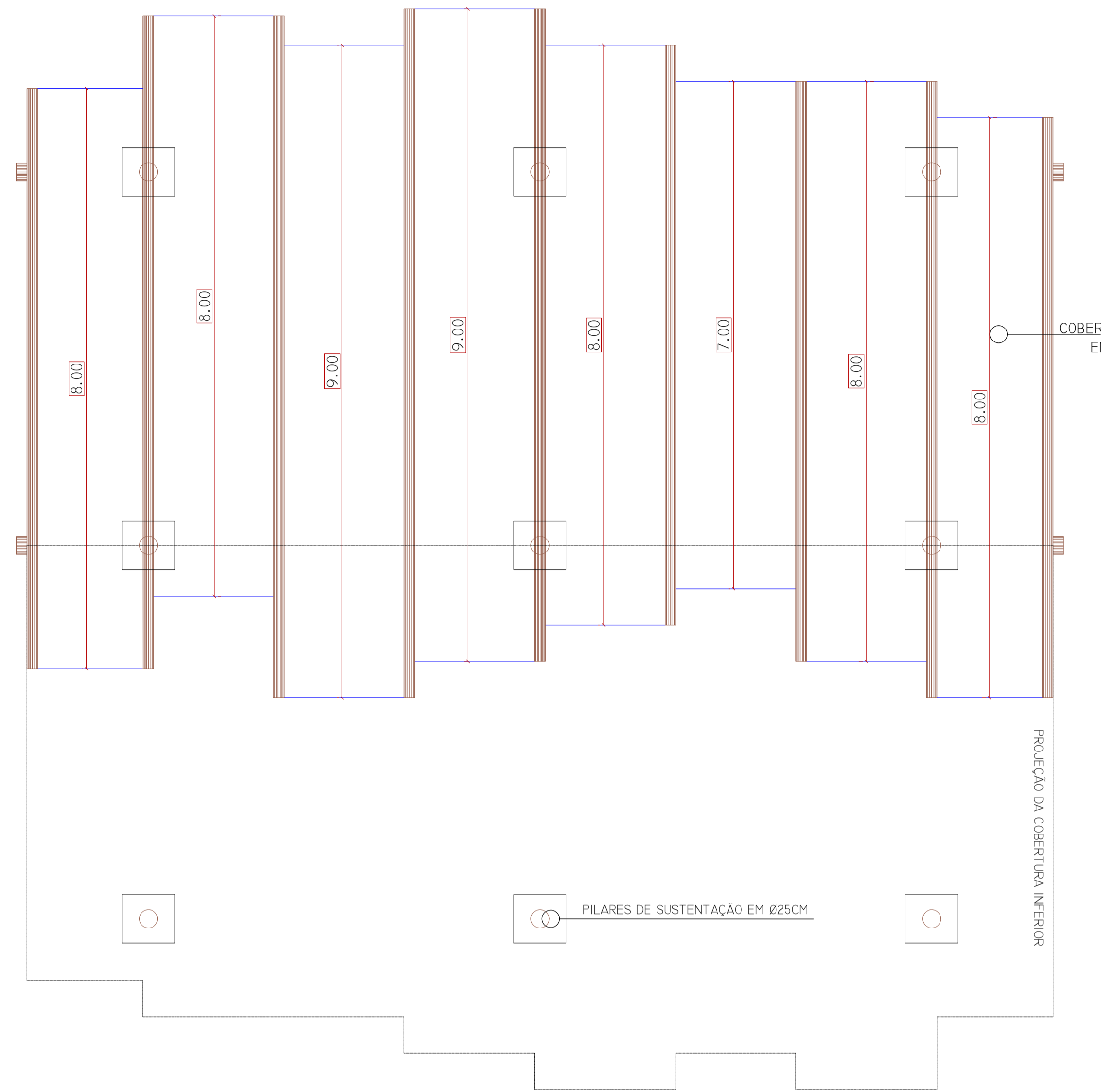
PLANTA BAIXA COBERTURA DE TELHA ONDULADA EM FIBRA DE VIDRO 6MM. - DETALHE ÁGUA SUPERIOR. ESC: 1/100
