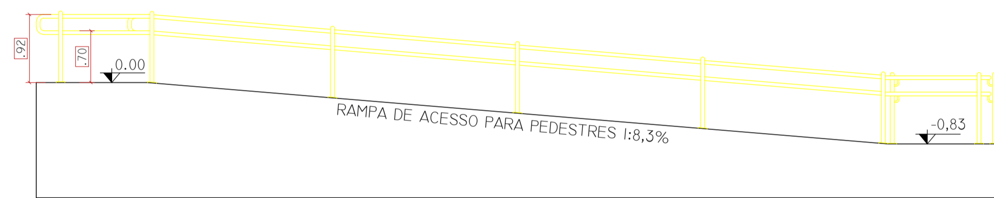
DETALHE 01 - VISTA 01 - RAMPA ACESSÍVEL. ESC: 1/50
